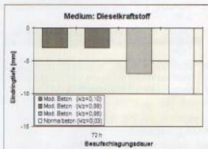
Abb. 5: Zusammenhang zwischen Polymergehalt und Eindringtiefe bei Dieselkraftstoff
