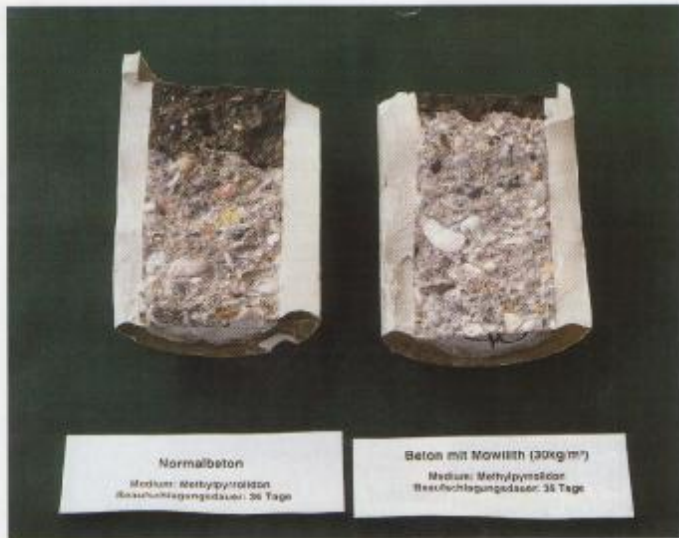
Abb. 8: Probekörper nach dem Spalten
